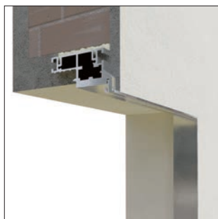
Profil obrátenej zárubne falce
